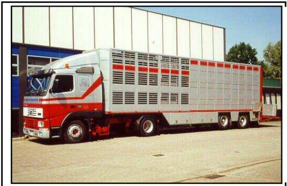
**Foto 7:** Transporter mit 2 Etagen für große Tiere, wie Rinder und Pferde. Kleinere Tiere, wie Schweine, Schafe und Ziegen, können in Lastern mit 3 Etagen transportiert werden (Quelle: <http://www.agrota-2l.hu/eng/index.html>).
